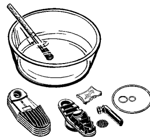
Limpeza manual da unidade de arrefecimento desmontada
