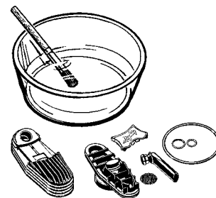
Ręczne czyszczenie rozłożonego modułu chłodnicy
