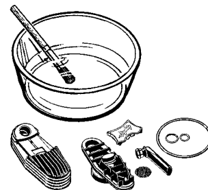
Manuel rengøring af den adskilte køleenheden
