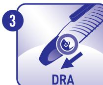
Plasser den blå forhøyningen (på hetten) parallelt med den hvite forhøyningen (på pennen), og trekk hetten av pennen. Du må kanskje bruke litt kraft.
